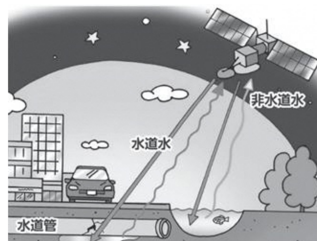
漏水調査イメージ
